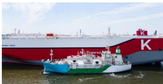
3,500m³型LNG燃料供給船「かぐや」 （国内初のShip to Ship 方式によるLNG 燃料供給 *CLMF社提供）
